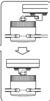
ナットが台座に水平にのるようにします。
